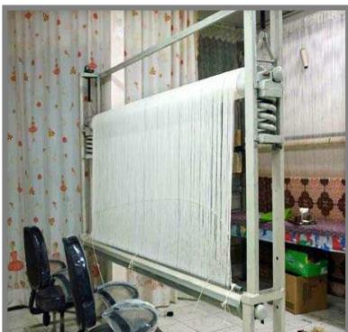
**کوچی:** وسیله‌ای چوبی یا فلزی می‌باشد که از آغاز تا پایان بافت قالی بر روی دار باقی می‌ماند. کوچی میله‌ای به طول کمی بیشتر از عرض دار و به قطر تقریبی ۴ یا ۶ سانتی‌متر می‌باشد و به کمک پایه‌های کوچک به روی دار قرار می‌گیرد. کوچی در دارهای افقی برای کنترل عرض قالی در حین بافت و همچنین برای نظم و انسجام بخشیدن به تارها و نیز برای جدا کردن تارهای زیر و روی قالی استفاده می‌شود.
